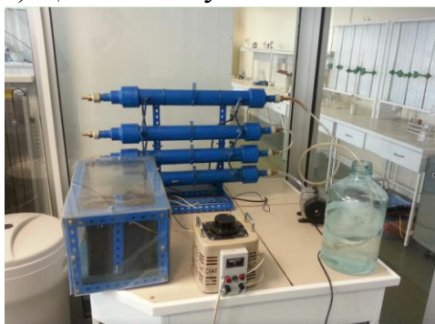
в) Шағын зертханалық үлгідегі озонатор қондырғысы арқылы суды залалсыздандыру
