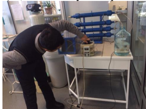
в) Шағын зертханалық үлгідегі озонатор қондырғысы арқылы суды залалсыздандыру
