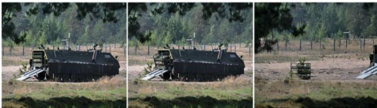
Рис. 6. Автоматизированная выгрузка боеприпасов в специальном контейнере
