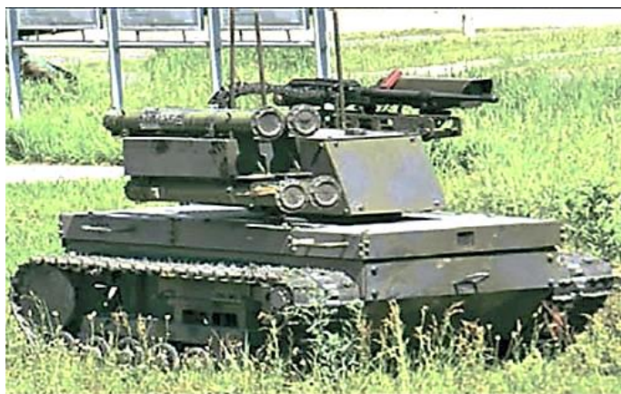
Рис. 2. Робототехнический комплекс «Платформа - М»
