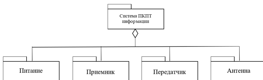
Рисунок 11. – Диаграмма пакетов системы приема командной и передачи телеметрической информации.
