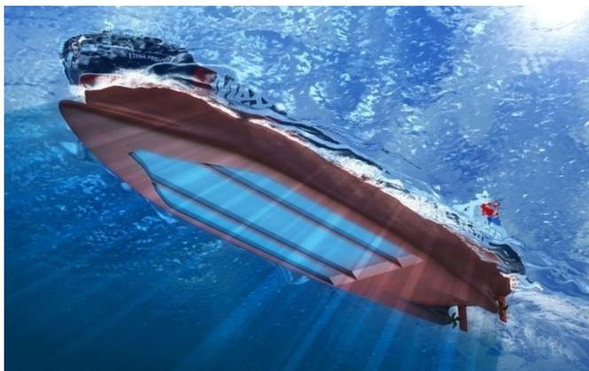
Рис. 1. – Судно с воздушной каверной на днище.
