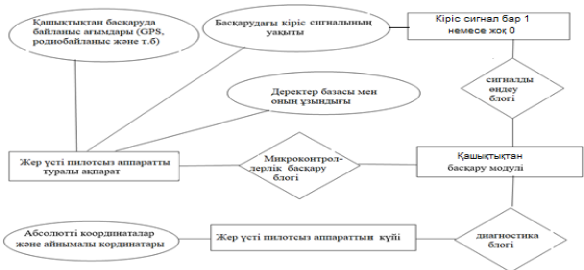
Сурет 6. – Микроконтроллерлік басқару негізіндегі мобильді автономды пилотсыз жерүсті аппаратын қашықтықтан кешенді іске асу сұлбасы.
