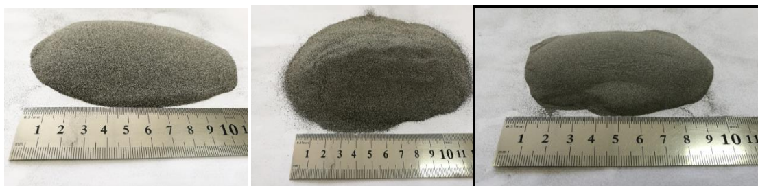
Рисунок 7. Образцы металлургического шлака после прокаливания
