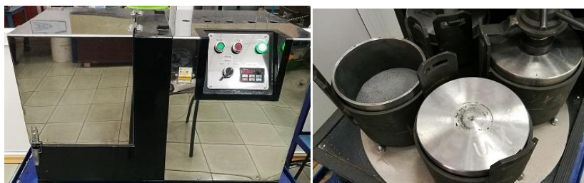
Рисунок 6. Лабораторная шаровая мельница
