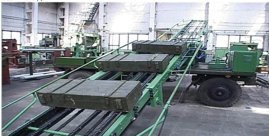
Рисунок 5 – Конвейер переменной геометрии 1Т829 для работы в складских и полевых условиях
