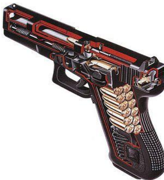
Рис. 4 Пистолеты системы Glock имеют три системы защиты от случайного выстрела
