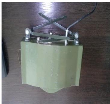
Рис. 3. Лазерный имитатор противопехотной мины
