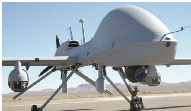
Рисунок 2 - Обзорно-прицельная система БЛА «Predator»
