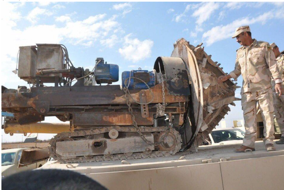
Рис. 2. Инженерная машина для строительства железнодорожных и автомобильных тоннелей.
