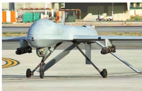
Рисунок 3 - БЛА «Predator» с двумя ракетами Hellfire
