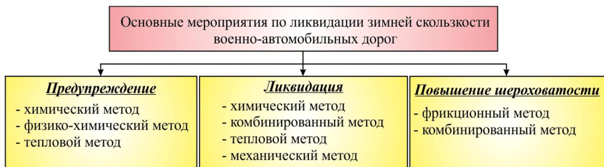
Рисунок 2 – Основные мероприятия по ликвидации зимней скользкости военно-автомобильных дорог
