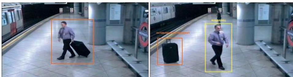
Рисунок 6 – Распознавание статичного и движущегося объекта
