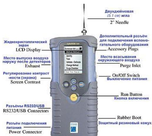
Рисунок 4 – Прибор на основе полупроводниковых газочувствительных датчиков типа «Электронный нос»
