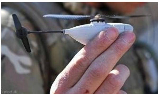
Рис.1. Дрон PD-100 Black Hornet, разработанный норвежской компанией Prox Dynamics. Этот дрон вертолетного типа имеет длину 100 мм и вес 120 гр
