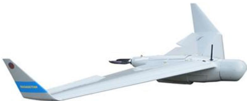
Комплексы состоят из 2-х БЛА (беспилотных летательных аппарата ) и наземной станции управления. Среднее время полете 1.2-2 часа, в зависимости от модели. Вся информация с установленных на беспилотниках датчиков передается на наземную станцию, которая может располагаться в радиусе до 15-ти километров. Общее время подготовки беспилотника СУНКАР к пуску, включая все предстартовые проверки и приготовления не превышает 15-ти минут.
