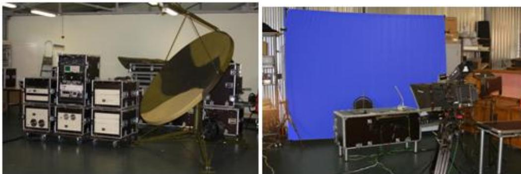
Рисунок 8. Переносимый телевещательный комплекс с виртуальной студией.
