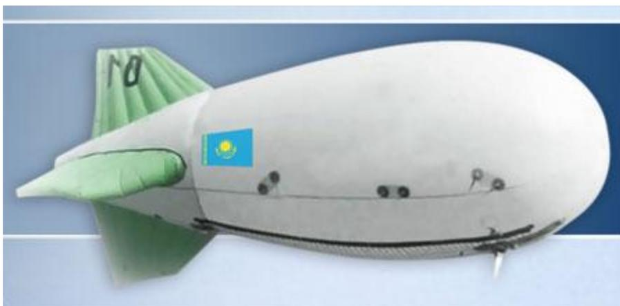
Комплекс для мониторинга на основе беспилотного дирижабля может быть использован как БПЛА или как привязной аэростат применяемый для постоянного круглосуточного наблюдения за объектом, а также проведениями исследовательских работ в одном месте, например снятие радиационных или метеорологических данных.
