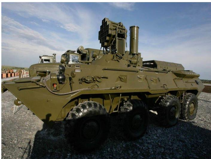
Рисунок 3. Звуковещательная станция ЗС-96 с бортовой «интеллектуальной» системой.
