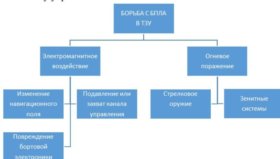
Рис. 1. Варианты борьбы с малоразмерными БПЛА (по материалам открытых источников).
