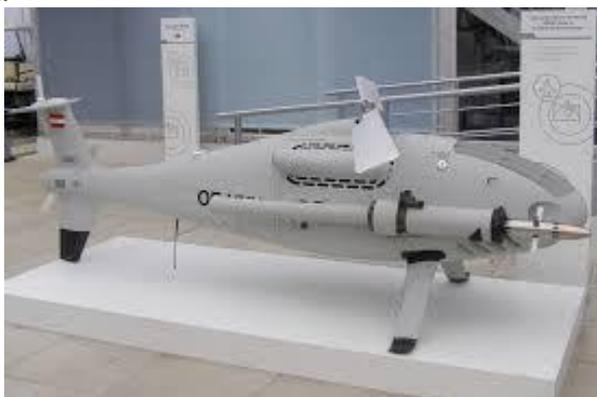
Рис. 2. Беспилотный летательный аппарат «Camcopter S-100» компании Schiebel (Австрия)
