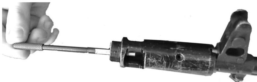
Рис. 3. Проверка износа канала ствола
