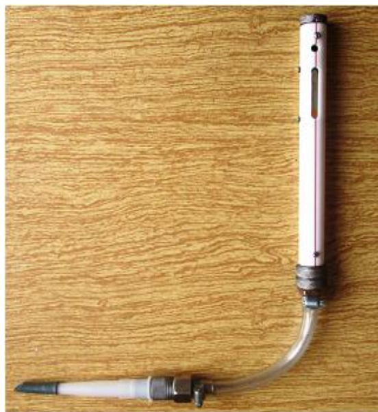
Рис. 2. Общий вид прибора для технического диагностирования герметичности деталей, узлов, агрегатов, полых изделий.
