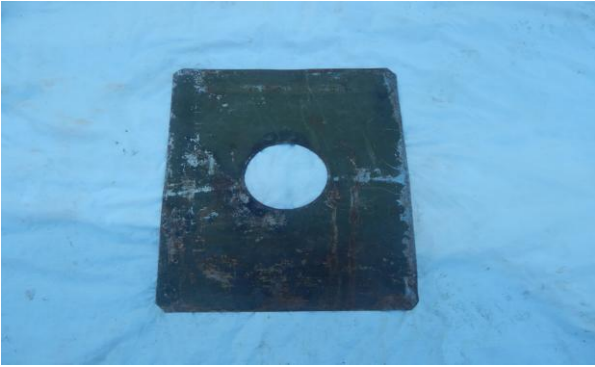
13-фотосурет. Түтіндік ойыққа арналған темір қаңылтыр.
