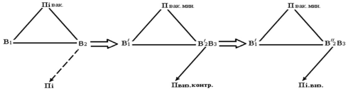
Рис. 1. Вепольная модель технического диагностирования герметичности системы питания дизельного двигателя воздухом.
