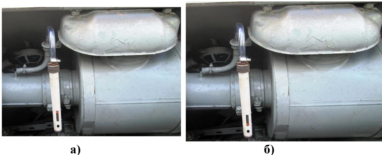
Рис. 5. Переносной прибор технического диагностирования системы питания двигателя воздухом бронетранспортёра БТР-80:
