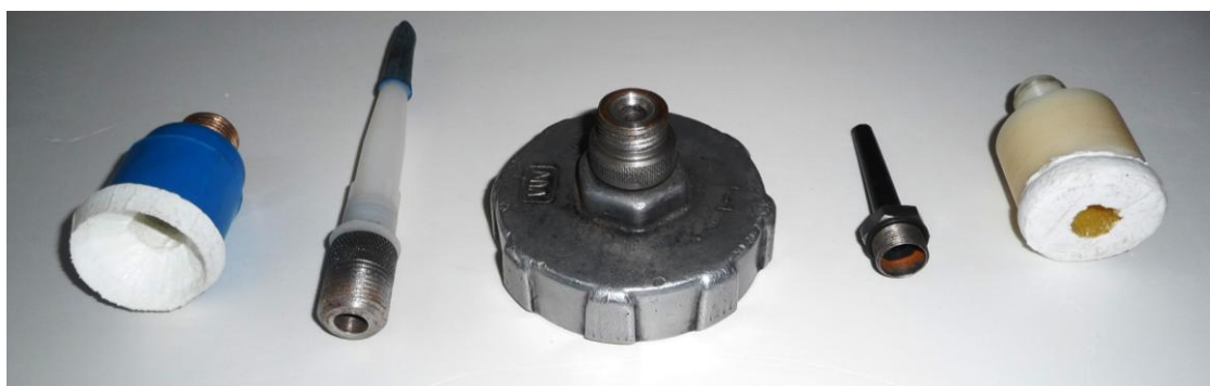
Рис. 3. Общий вид насадков устройств для контроля герметичности
